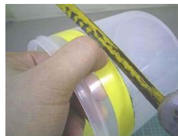
図 3-7-1-3 円筒容器の開口部側を手で押さえ、粘着テープの縁に沿って鋸で切る。切り始めは刃がズレやすいが、爪を鋸の刃の側面に添えるとズレにくくなる。容器の内側を傷つけない。
