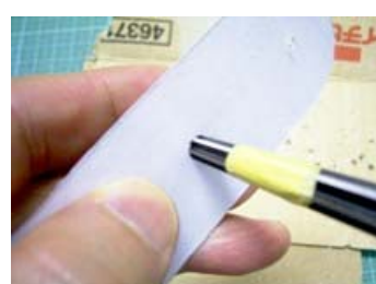
図 3-13-2-8 チューブが通らなかった穴を広げる
