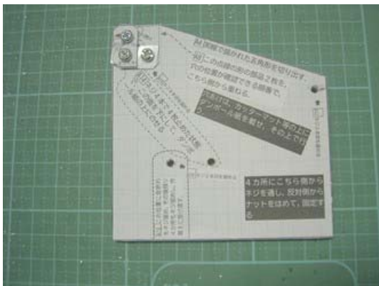
図 3-5-1-16 アルミバットに金折れを残し，塩ビ板の部品を「『クランク軸とフライホイール以外』の機構部の部品」を切り出している作業に戻る
