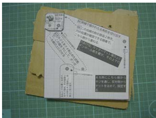
図 3-4-1-3 ネジを締めてもズレるので、丁寧に位置を合わせ、ドリルを当てて回すときも慎重に回す。
