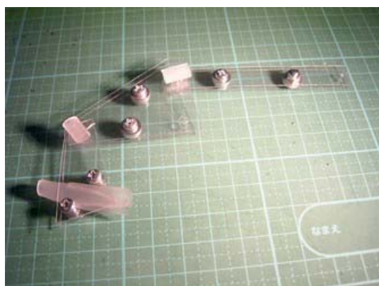
図 3-10-1-1 クランク軸からディスプレイサまで動きを伝えるリンク
