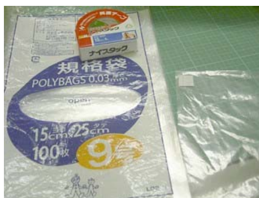
図 3-12-1-2 材料の両面テープ「ナイスタック」幅 15mm×長さ 15mm を，材料にもなるポリ袋に張り付ける．
