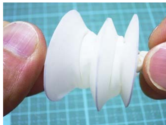
図 3-13-2-37 漏れが無ければ，伸びた状態で「チューブジョイントが挿しこまれたチューブ」を指で塞ぐと，ベローズは押しても縮まない
