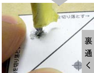
図 3-14-1-3 1人作業の場合は2枚重ねで穴あけ加工して時間短縮
