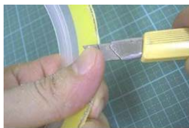
図 3-7-1-5 バリをカッターナイフもしくはバリ取り用の工具で落とす
