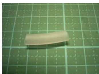
図 3-13-2-18 φ6mmの穴に押し込む、長さ約2cmのチューブを用意しておく
