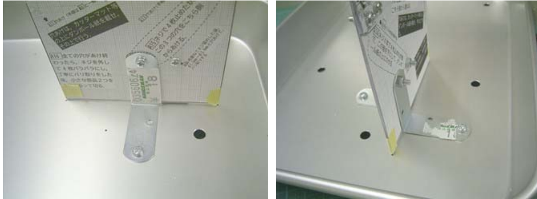
図 3-5-1-14 アルミバットに金折れ二つをネジ留めして，塩ビ板の位置が揃う事を確認したら，
