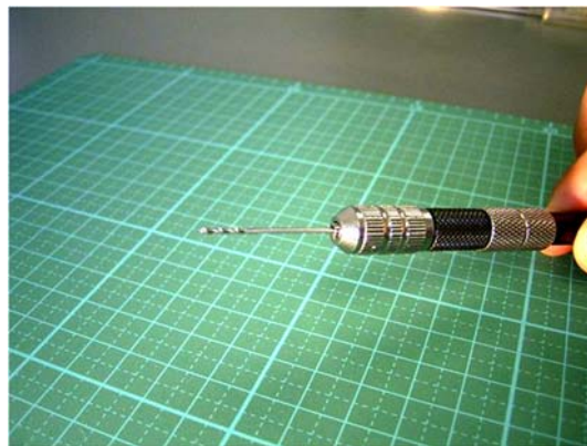
図 3-3-1-2 コレットチャックを締め，ドリルが緩まないようにする
