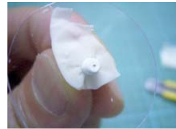
図 3-13-2-26 天然ゴムの傷は小さい
