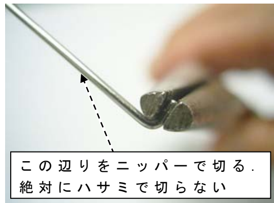
図 3-9-1-6 折り曲げて切る．切り落とす長さは「指でつまめる範囲内で短く」
