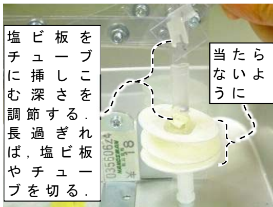
図 3-15-5-5 「クランクが一番下がる状態」にしたとき、ベローズの中の部品が互いにぶつからないようにする
