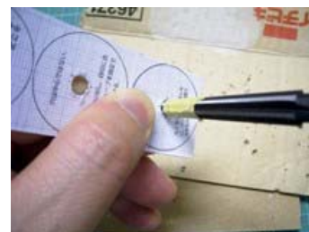
図 3-13-2-11 次の穴を、型紙の指示に従って、広げる
