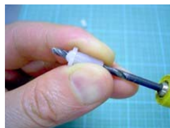
図 3-13-2-17 短く切り落としたチューブジョイントの中をφ3.0mmのドリルでさらい、狭窄を改善する
