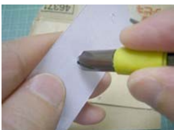
図 3-13-2-9 再びチューブを当ててチェックする前に裏表でバリ取りをする
