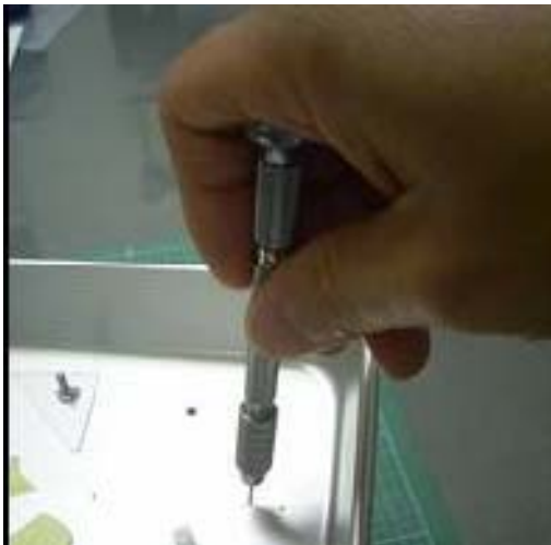
図 3-3-1-5 指の付け根で後端を押さえて，片手で扱えるピンバイスもある
