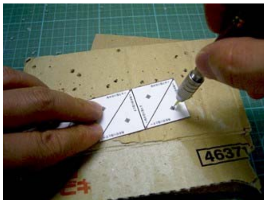
図 3-14-1-7 重ねずに下穴を10個あける
