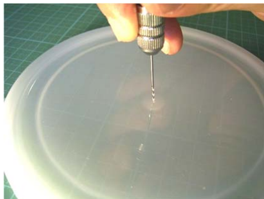
図 3-3-1-3 目印の中心にドリルの先端を添える
