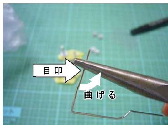
図 3-8-4-15 ゼムクリップの部品を，外して，油性ペンの目印に合わせてラジオペンチでつかみ，曲げる
