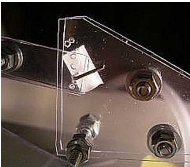
図 3-15-7-3 ディスプレーサの往復動の距離は 5 つ並んだ \phi 1.0\text{mm} の穴のどれを使うかによって，多少の調節ができる．これを変更すると，フライホイールのバランスを取り直す必要がある．
