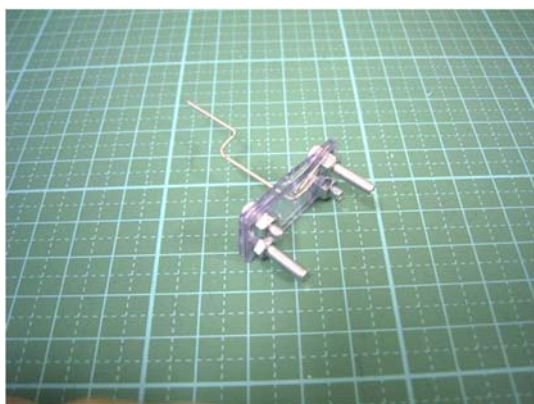
図 3-8-4-1 フライホイールを取り付ける部品が設けられたクランク軸
