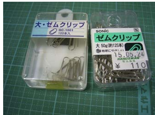
図 3-9-1-2 材料になるゼムクリップは線径 1mm 未満のもので，折り曲げても折れにくいものにする
