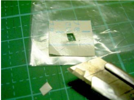
図 3-12-1-3 \phi 1.0\text{mm} の穴より大きな穴を両面テープにあける
