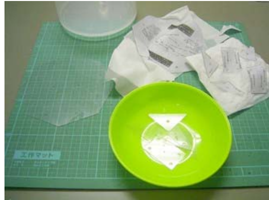
図 3-8-2-10 型紙はきれいにはがして捨てる．塩ビ板は水や残ったノリをぬぐいとる．透明な部品は無くなりやすいので注意
