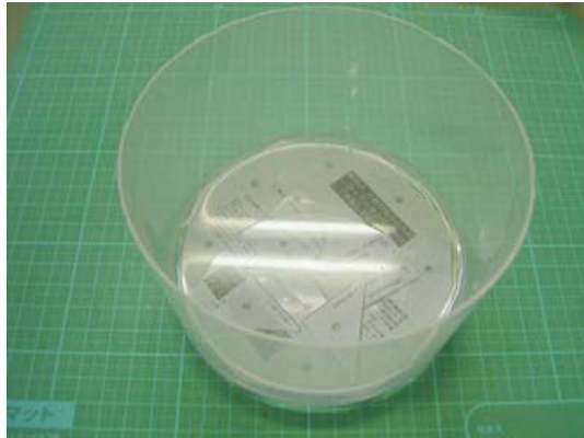
図 3-8-2-9 バリをとった後，型紙が貼られた塩ビ板を水で濡らす
