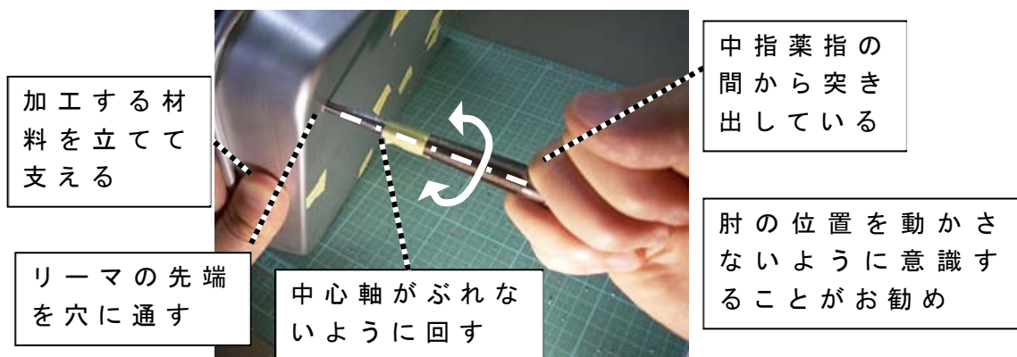
図 3-3-2-1 穴に先端を通したリーマを，軽く押しながら，中心軸がぶれないように注意しつつ，左右に回転させ，穴を広げる
