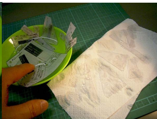
図 3-10-1-4 型紙は水に漬ければきれいに剥がれる。水に漬けにくい大きさの部品も濡らして少し待てば，型紙がはがれる。
