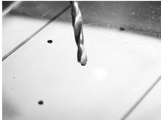
図 3-3-4-2 下穴を開けるドリルは、先端の尖ったところを目印の中心にあてる
