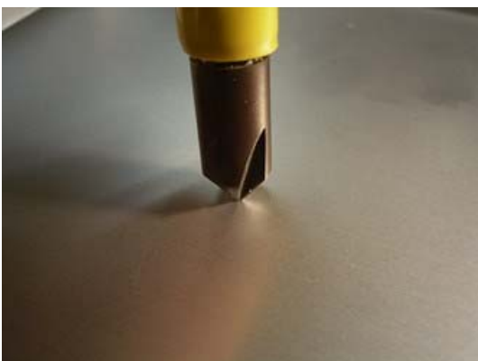
図 3-3-1-8 穴を開けた後のバリは面取り用ドリルを押し当てて回すと処理できるが， \phi 1.0\text{mm} の穴は \phi 3.0\text{mm} のドリルで代用できる．バリ取りで穴も拡大するのでやり過ぎない
