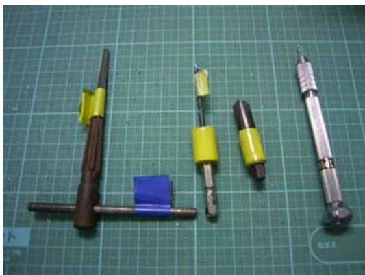
図 3-3-2-4 リーマの握り部分に通す金属棒は，そのままだと作業中頻繁に抜け落ちるが，端にテープをつけると落ちない
