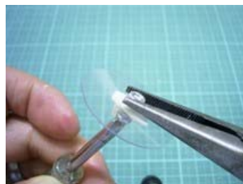
図 3-13-2-28 ナットにネジをねじ込み，その後はナットとナットをしっかりと締める
