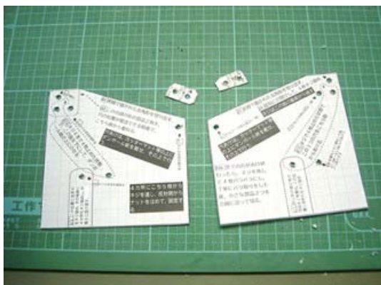
図 3-4-1-5 ネジを外し，バリを取り，小さな部品も \phi 1.0\text{mm} の穴を切る
