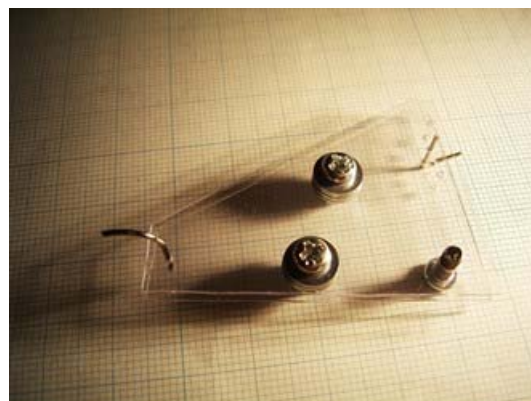
図 3-10-2-3 緩みなくネジを締 める際に、穴の位置を揃える。
