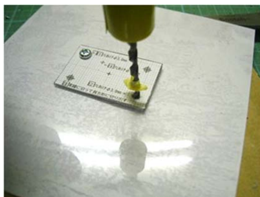
図 3-8-2-4 2 本目のネジの通りが悪ければ，1カ所ネジ留めしたまま二つめの穴を揃え， \phi 3.0\text{mm} のドリルでさらう
