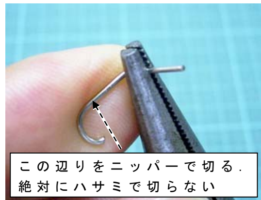
図 3-9-1-4 リンク機構の軸に使う 2 本は，曲げる長さをミリ単位で気にするようなものではない．曲げてから，弧を描いている部分をニッパーで切る
