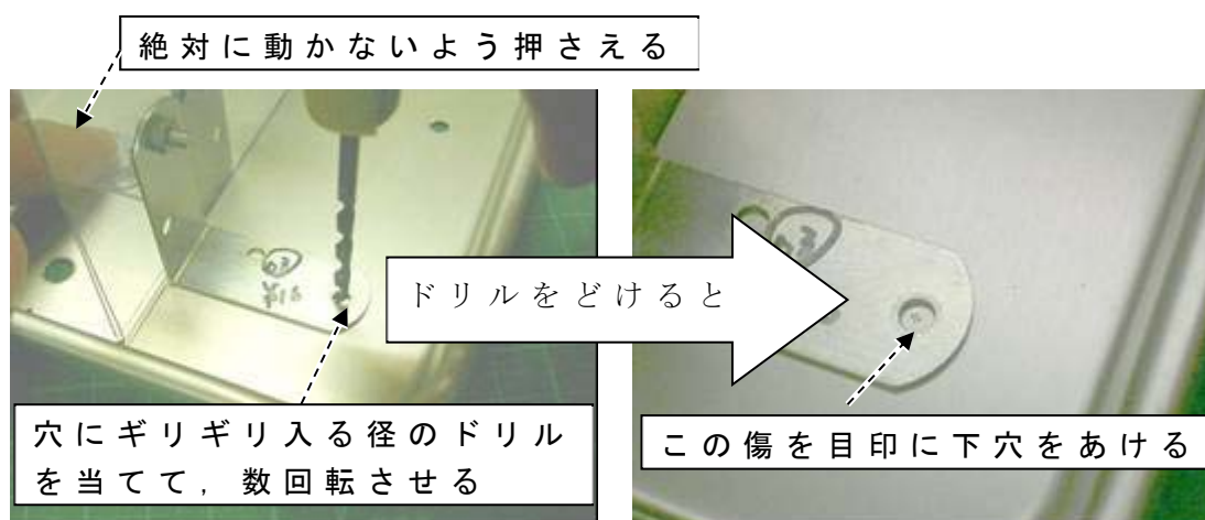
図 3-3-3-5 別の部品の穴の位置に合わせて、新しい穴をあける
