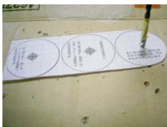
図 3-13-2-3 \phi 1.0mm の下穴を \phi 3.0mm のドリルで拡大する
