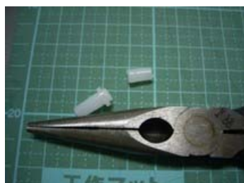
図 3-13-2-16 ニッパーでチューブジョイントの片方を切り落とす
