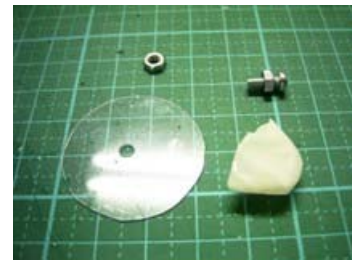
図 3-13-2-23 \phi 3mm の穴がある円盤，ゴム手袋の指先，真ん中過ぎまでナットに通した M3×8mm のネジ，更にナットが一つ
