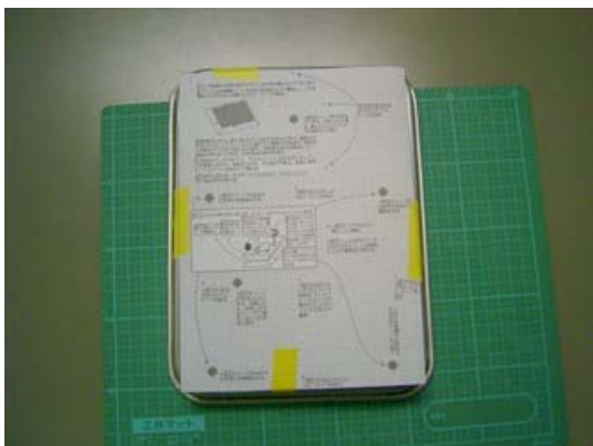
図 3-5-1-3 裏返したアルミバットの底にテープで型紙を貼る
