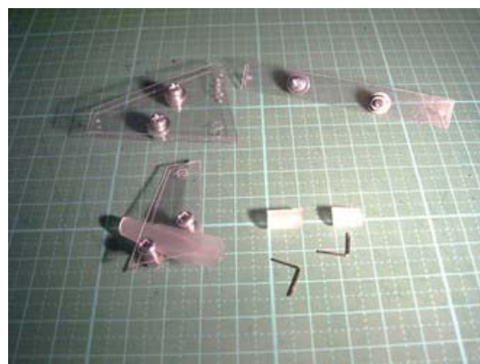
図 3-10-2-6 組立てたリンク 3 種類とゼムクリップから作った「リンク機構で使う軸」2 本，長さ 1 cm 弱のチューブを用意する
