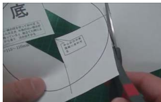
図 3-3-5-1 ハサミの刃先は常に自分の正面に向け，切る方向を変える時は切る物を動かす．切る物を押さえる手が持つ位置は，ハサミの刃の横であり，ハサミの刃の先の延長線上ではない．そしてハサミの上の刃が，切る線に乗っていくのを目で確認しながら切る
