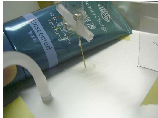
図 3-12-1-6 ポリ袋の切れ端を，ディスプレイサロッドが貫いた状態で，アルミバットにシワなく張り付け，摺動部にハンドクリームを塗る．
