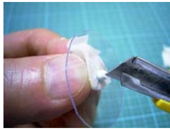
図 3-13-2-25 \phi 3.0mm の穴から突き出たネジを覆う天然ゴムに傷をつける
