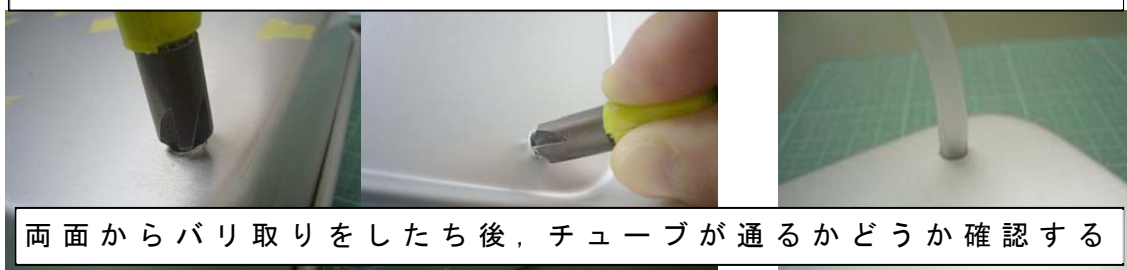
図 3-3-2-3 チューブを固定する穴は，チューブが丁度通る大きさになるまで，面取り用ドリルの仕上げと大きさのチェックを繰り返しながら，少しずつ穴を大きくする
