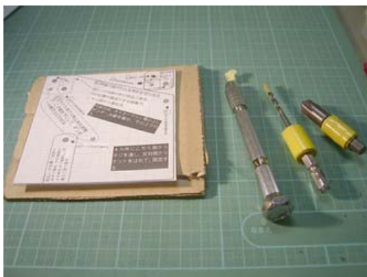
図 3-3-1-13 硬質塩化ビニル板のように，たわんでしまう材料は当て板で支えて加工する
