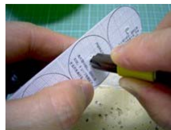
図 3-13-2-5 穴の大きさを確かめる前にバリ取りをする。
