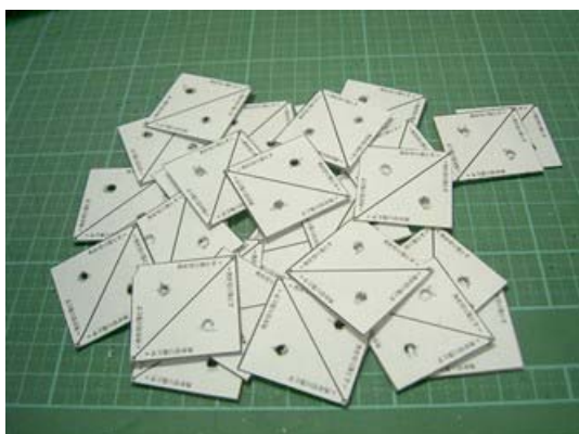
図 3-14-1-10 2 個一組の正方形 30 個に切り出す。
