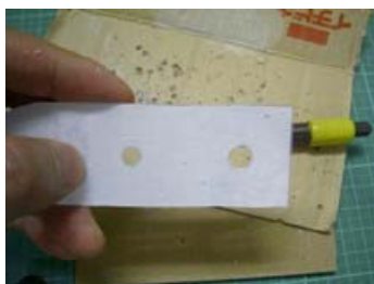
図 3-13-2-13 バリを処理して穴の加工は終わり
