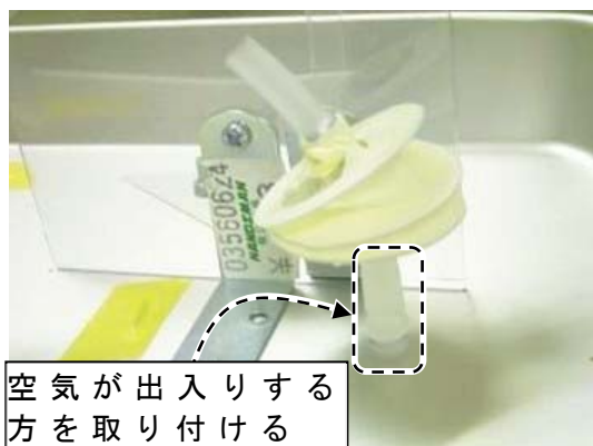
図 3-15-5-1 クランク軸の真下のチューブにベローズを取り付ける
