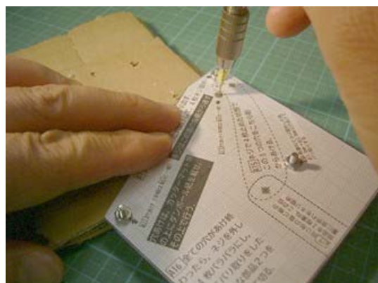
図 3-4-1-4 4 枚の塩ビ板をネジ留めして加工するが、塩ビ板が反らないように、穴をあける場所には当て板を当てるが、ネジを当て板に乗せない
