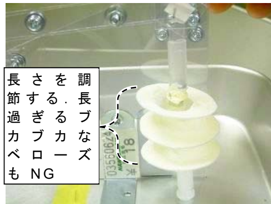
図 3-15-5-6 「クランクが一番上がる状態」にしたとき、ベローズが伸び切らないで少しだけ余裕がある状態にする
