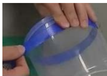
図 3-7-1-2 円筒容器内側のテープのフチに合わせ、フチから 38 mm の目印となるよう、外側からテープを貼る
