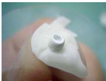
図 3-13-2-27 天然ゴムの傷を広げ，ナットをかぶせる
