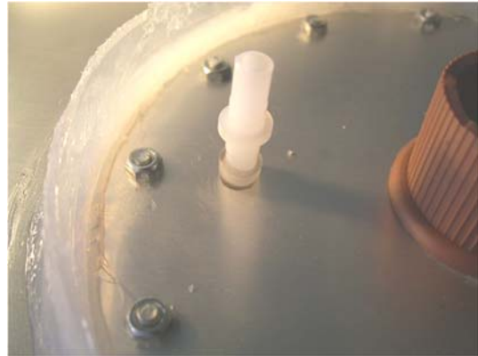
図 3-3-2-6 チューブジョイント固定の手順 2 では，チューブにチューブジョイントの先端を挿し入れる
