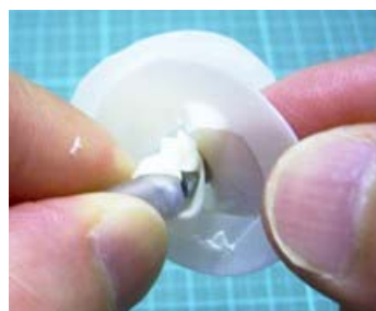
図 3-13-2-34 ネジの頭に 2 cm 程度のチューブを取り付ける
