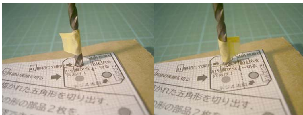
図 3-3-1-15 \phi 3.0\text{mm} のドリルにも目印をする
