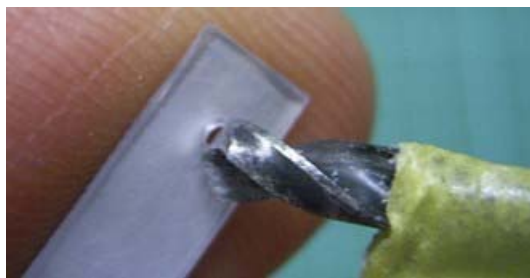
図 3-13-3-2 穴をあけて切り出した後は，バリをとる． \phi 1.0\text{mm} の穴のバリは，面取り用ドリルより， \phi 3.0\text{mm} のドリルの方が作業をしやすい
