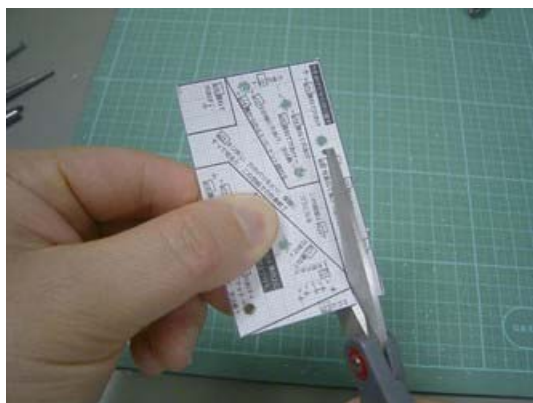
図 3-3-5-1 ハサミの刃先は常に自分の正面に向け，切る方向を変える時は切る物を動かす．切る物を押さえる手が持つ位置は，ハサミの刃の横であり，ハサミの刃の先の延長線上ではない．そしてハサミの上の刃が，切る線に乗っていくのを目で確認しながら切る
