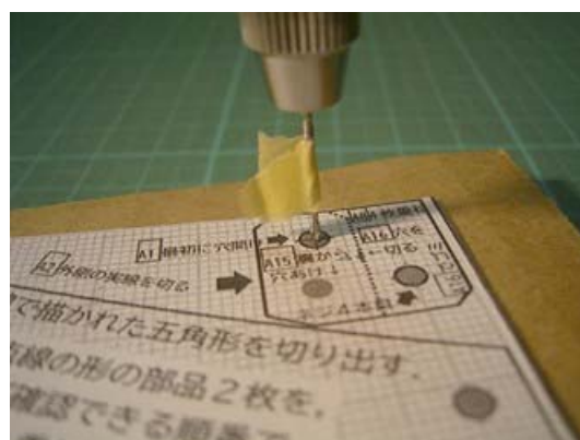
図 3-3-1-14 不透明な材料に当て板をして穴あけ加工をしていると，ドリルの進み具合が確認しにくいので，目印をドリルにつけた
