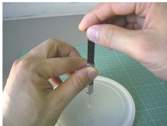
図 3-3-1-4 ピンバイス中ほどの回転するところを保持して適度な力で材料に押し当て，ピンバイス端部を持って時計回りに回す
