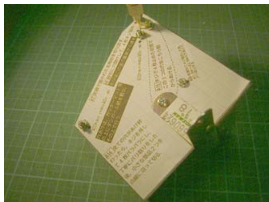
図 3-4-1-6 バリ取りした塩ビ板の部品を再度ネジ留めし金折れを取り付け， \phi 1.0\text{mm} の穴の位置が揃っていることもドリルや金属線を通して確認
