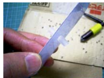
図 3-13-2-10 チューブが通ったら、その穴の加工は終わり
