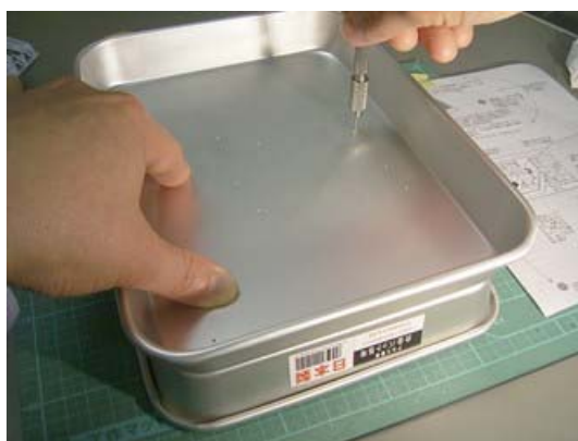
図 3-5-1-7 はがした型紙を隣に置き，型紙の指示を見ながら，作業をする．この図は 2 枚目のアルミバットに 4 つの穴の目印をつける様子である．
