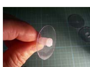
図 3-13-2-20 塩ビ板が醜くゆがんでいる場合は、塩ビ板が歪んでいるので、少し穴を広げる
