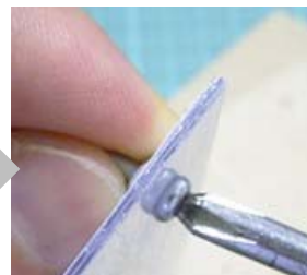
図 3-14-1-3 1人作業の場合は2枚重ねで穴あけ加工して時間短縮
