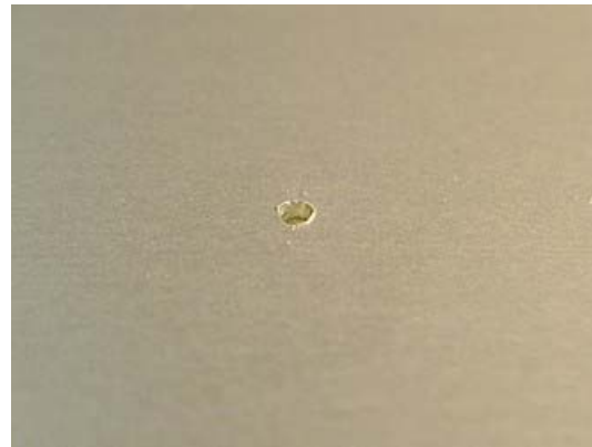
図 3-3-1-10 バリによっては，見た目に目立たないが，指でなぞると引っ掛かりがある（アルミ材の \phi 1.0\text{mm} の穴）
