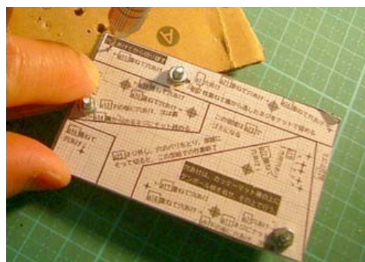
図 3-4-2-3 型紙のついた塩ビ板 2 枚を重ねてネジで固定し，穴をあける
