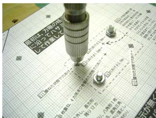
図 3-8-2-6 塩ビ板を 3 枚重ねた状態で， \phi 1.0\text{mm} の下穴もあける
