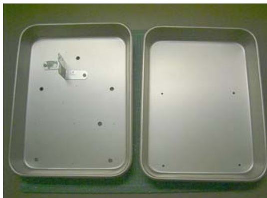
図 3-5-1-1 アルミバットに金折れ二つをネジ留めしたものと、 穴が 4 つあるアルミバット
