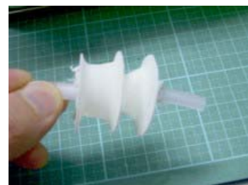
図 3-13-2-35 チューブジョイントが挿しこまれたチューブを指で塞いだ時，漏れが無ければ，ベローズは形を保つ
