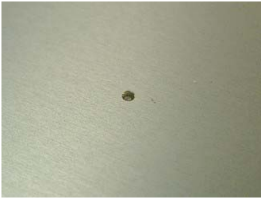
図 3-3-1-9 バリをとった，アルミ材の \phi 1.0\text{mm} の穴
