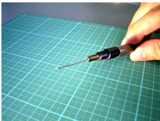
図 3-3-1-1 コレットチャックを外したピンバイスにコレットを入れ，コレットにドリルを入れる
