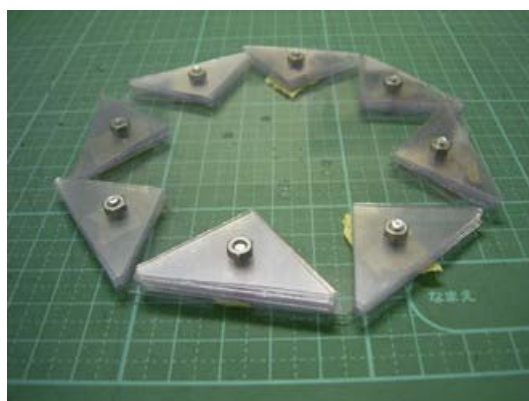
図 3-14-1-15 フライホイールにバランスウェイト 60 個を取り付け、ナットを手で絞めておく
