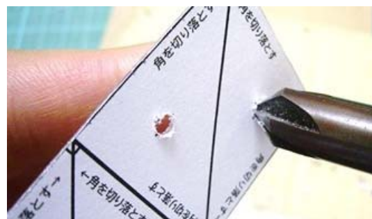
図 3-14-1-9 10カ所 \phi 3.0\text{mm} の穴があいた10個組を，更に次の人が面取りする
