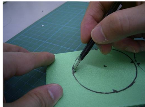
図 4-14 カラー発泡パネルの切り出し
