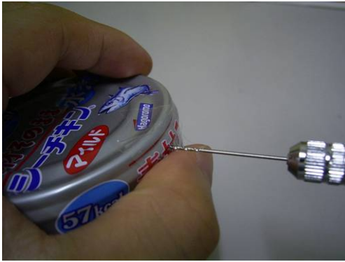
図 4-3 ミニステータ取り付け部の穴あけ
