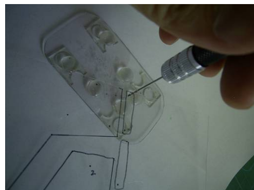
図 4-32 硬質塩化ビニル板の穴あけ加工
