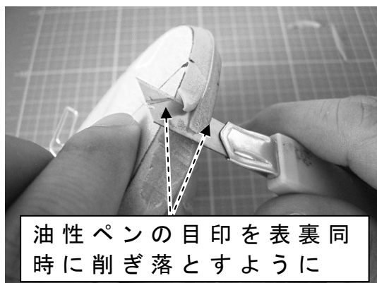
図 3-6-3-15 二枚の円盤を粘着テープで仮留めし，側面をカッターナイフで削る
