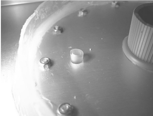
図 3-4-4-5 チューブジョイント固定の手順1では，短く切ったチューブを穴に挿す
