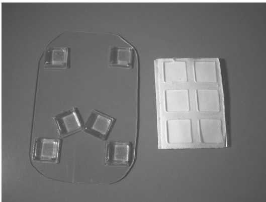
図 3-4-1-13 PU ゴムの枠の部分も使うので丁寧に外し、PU ゴムのクッションを硬質塩化ビニル板の表側、四隅と V 字型の隙間を形成する中央付近二箇所張り着ける
