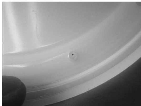
図 3-5-4-6 透けて見えるボルトを参考にして，油性ペンで中心の目印を入れる
