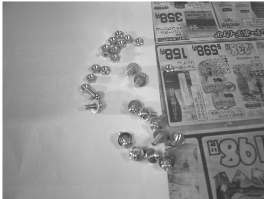
図 3-5-5-15 ナットとワッシャーに通した M3×8mm のボルトを用意しておく
