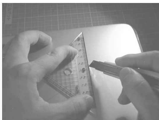
図 3-5-2-9 シリンダの中心で直角に交わる2直線をカッターナイフでなぞる
