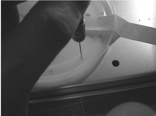
図 3-5-4-7 アルミトレイ上の の \phi 3.0\text{mm} の穴と同じ位置に 2つだけ穴をあける
