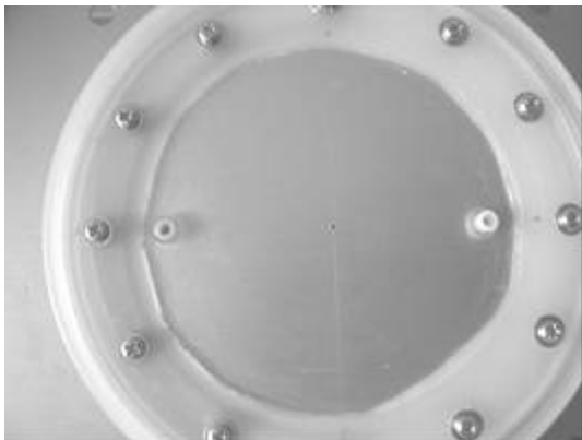
図 3-5-1-1 シリンダヘッドの裏には食品保存容器のフタから切り出した部品がボルトで留められ，アルミトレイとの隙間がバスコークで埋められている
