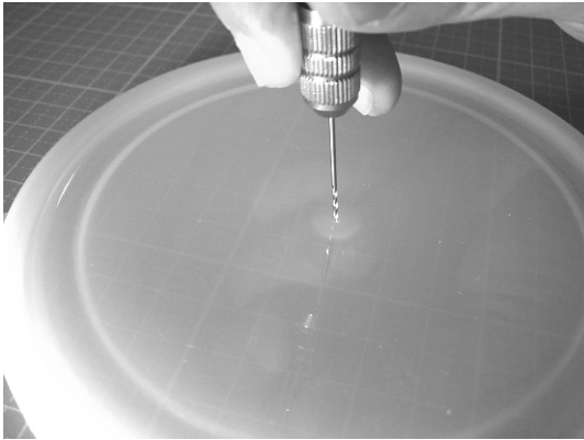
図 3-4-1-3 目印の中心にドリルの先端を添える
