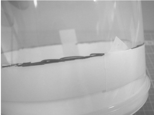
図 3-5-3-8 型紙の位置にあわせて，外側から不透明な粘着テープを張る
