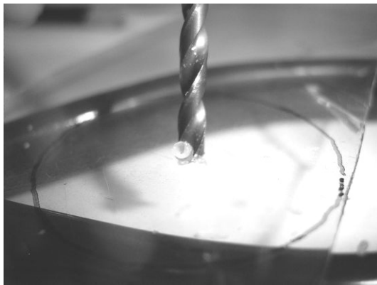
図 3-4-1-5 力加減が強過ぎる時の切り屑
