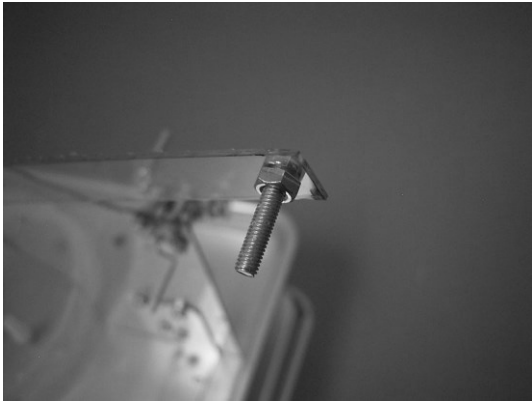
図 3-8-5-19 カウンターウェイトの数を決める手順 1 : 部品⑥の端に 15mm のボルトをナットで固定する
