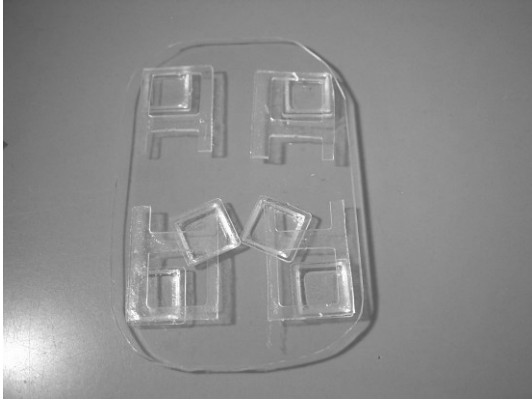
図 3-4-1-11 穴あけ加工する硬質塩化ビニル板を支える道具を作った方が便利
