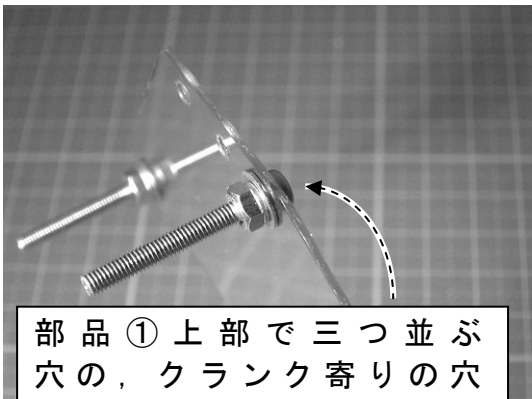
図 3-8-4-42 スプリングワッシャーがつぶれるまでナットを締める
