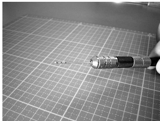
図 3-4-1-2 コレットチャックを締め、ドリルが緩まないようにする
