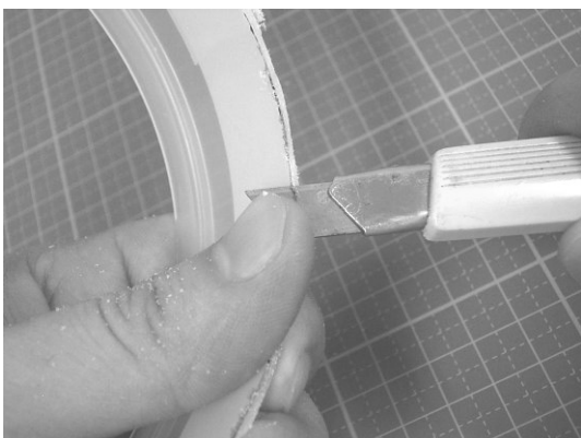
図 3-5-3-12 油性ペンの目印は切り落とす場所なので，バリと共に油性ペンの目印もカッターナイフで落とす
