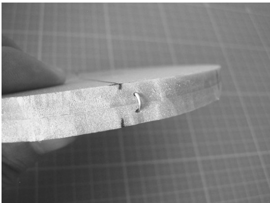
図 3-6-3-21 U字の部品を2つの線分と外周の交点の近傍の側面に深く差し込む
