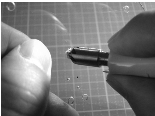
図 3-8-4-21 面取り用ドリルでバリを取り、再びボルトが通るかチェックし、円滑に組み上がるまで穴の拡大とバリ取りとチェックを繰り返す。
