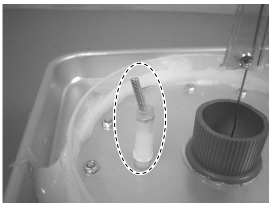
図 3-8-5-38 空気抜きの穴のチューブをボルトでふさぐ
