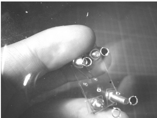
図 3-8-4-19 目印を合わせて部品⑫と円滑に組み合わせることを確認する
