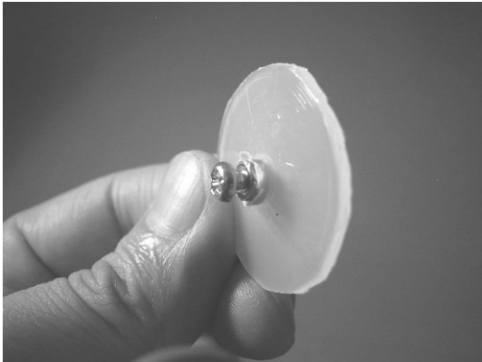
図 3-7-3-15 ゴムの切れ端が残っていても構わないが、ボルトのついた円盤の完成
