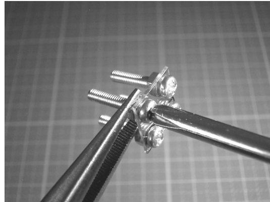
図 3-8-4-27 ナットをしっかりと締める
