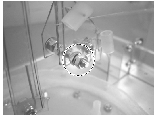
図 3-8-5-37 部品⑨のリンクを留めるボルトも同様に，ナットの間のスプリングワッシャーはつぶすが，リンクを締め付けすぎないように加減する
