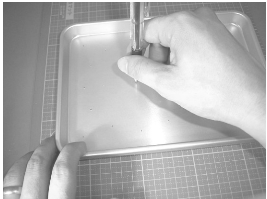
図 3-5-2-14 新しいアルミトレイを裏返して置き、その上に目印を入れて下穴をあけたトレイを載せ、トレイの下面同士を合わせ、シリンダの中心から 80\text{mm} の距離にある \phi 6\text{mm} の穴4つとシリンダの中心を写す
