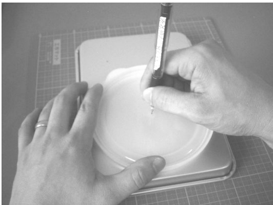
図 3-5-2-4 裏返したアルミトレイに裏返したフタをトレイからはみ出さないように載せ、フタの中心の穴を通してシャープペンシルでアルミトレイに目印を入れる
