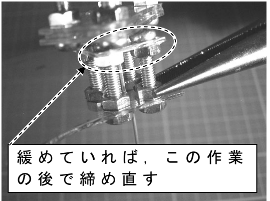
図 3-8-4-33 ボルトの中程にあったナットで部品①を締めつける
