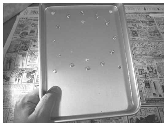
図 3-5-5-23 ナットを締めるが、締め過ぎは厳禁で、手締めが良い
