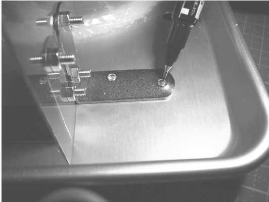
図 3-8-4-46 シリンダヘッド部の目印に合わせて機構部を乗せ，金折れ外側の穴の位置が分かるようにシリンダヘッドに油性ペンで目印を入れる
