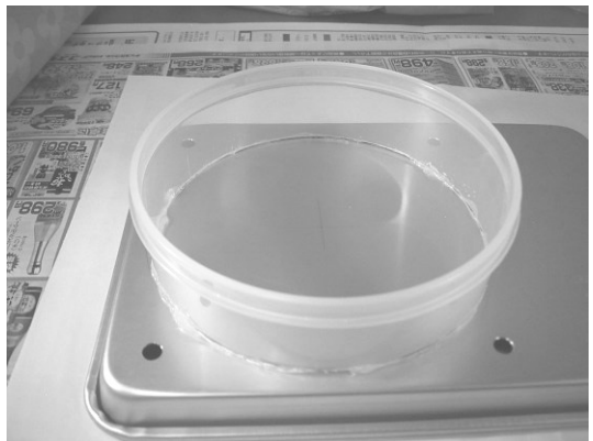
図 3-5-5-6 シリンダの底の線に合わせて、バスコークを塗った切り口を載せる
