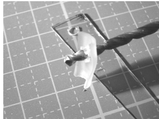
図 3-8-5-8 チューブの穴にドリルが通った状態で, 穴は丸くない
