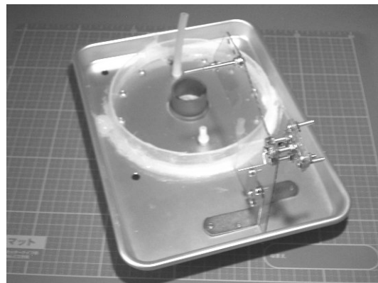
図 3-8-4-43 シリンダヘッド部をはずし，組立てている機構部を乗せる
