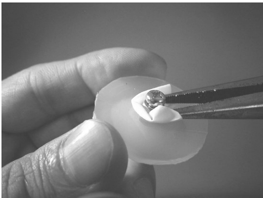
図 3-7-3-13 最初にボルトに通していたナットを締めて、円盤を二つのナットではさむ
