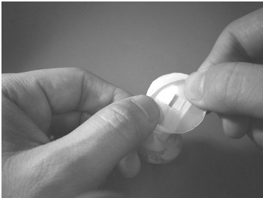
図 3-7-3-17 筒状のゴムの反対側から、穴のあいた円盤を入れる
