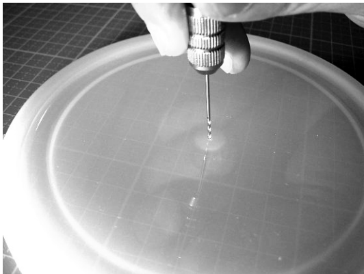
図 3-5-2-3 アルミトレイに目印を入れる際に使う \phi 1.0\text{mm} の穴をフタの中心にあける
