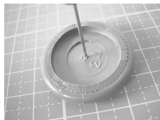
図 3-7-2-6 木足ゴムから切り取った材料の中心に下穴をあける
