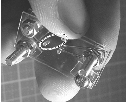
図 3-8-4-17 目印を参考にして部品の向きや表裏を合わせ、もう一つの部品③をはめ、ナットを締める
