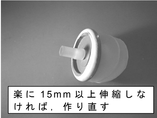
図 3-7-3-23 突き出したチューブジョイントを, 長さ 1cm 程度に切り出したチューブに差し込み, ベローズが完成
