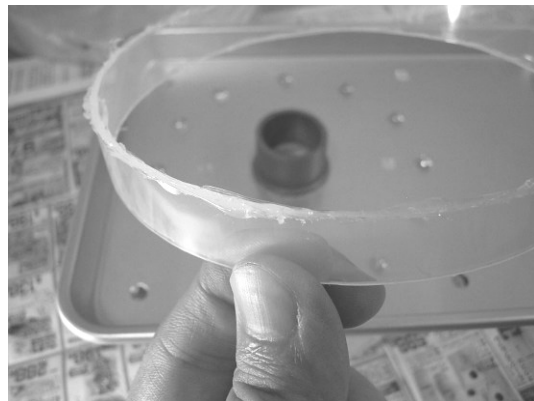
図 3-5-5-27 湯溜めの枠にも、シリンダ同様にバスコークを最初に塗る
