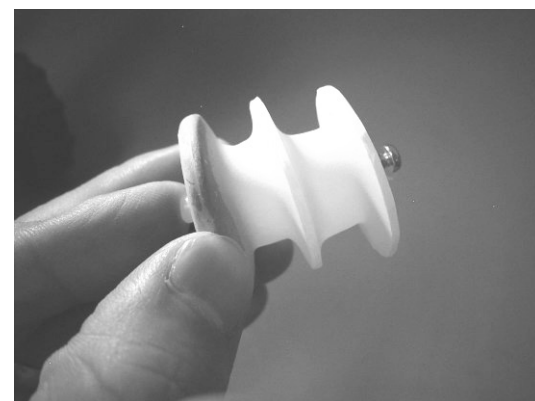
図 3-7-3-22 円盤の位置を調節し、膨らみがチューブジョイントを塞いだ状態で維持できるまで、一連の作業をやり直す
